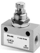
Porque la velocidad de un cilindro se regula interceptando el aire de la cámara que está descargando, se debe conectar el orificio roscado 1 con la entrada del cilindro y el 2 con la utilización de la válvula.
