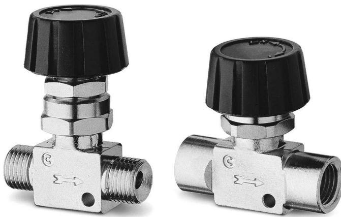
Son válvulas de regulación bidireccionales construidas enteramente de latón niquelado con juntas de goma NBR y mando de tecnopolímero. Son aptas para la regulación de aire comprimido, así como agua y aceites minerales. Para los modelos 2810, 2820, 2819 y 2829 existe la posibilidad de conectar directamente tubo de plástico o tubo de bronce y latón, utilizando la tuerca y las ojivas 1310/1320.
