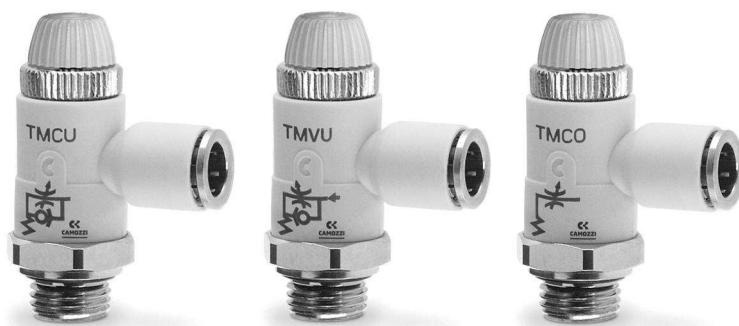
Estos reguladores de flujo unidireccionales y bidireccionales Serie TMCU, TMVU y TMCO han sido realizados mejorando las características de caudal y regulación. La construcción permite un montaje simple en cilindros y en válvulas, logrando una regulación gradual de la velocidad del cilindro.
