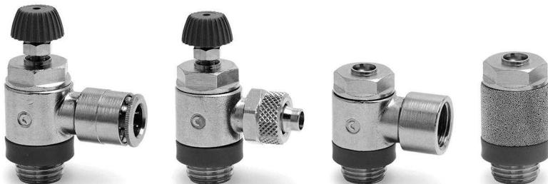
Estos reguladores de flujo unidireccionales y bidireccionales han sido realizados para ser montados directamente en válvulas o cilindros a fin de reducir al máximo las dimensiones. La vasta disponibilidad de racores orientables ha permitido que el regulador esté integrado con el sistema más apto para el tubo que se va a utilizar.
